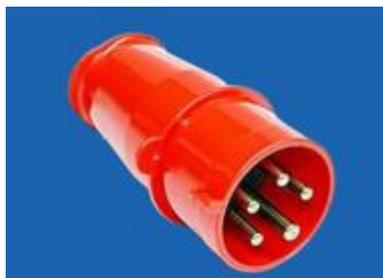
**A instaladora entregará uma tomada steck fêmea. A montadora deverá fazer essa conexão de alimentação de energia com um plugue Newkon 3P+N+T STECK modelo N5276 vermelho (tensão fase/fase 380V - tensão fase/neutro 220V – O aterramento no pino mais grosso do Plugue conforme padrão).**
